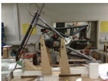
Imagen 5. Primer concepto de chasis que se aproxima al proyecto definitivo. La sucesión de pruebas y validaciones tanto en taller como informáticas se fueron realizando para tomar decisiones técnicas.
