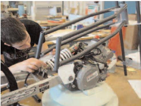
Imagen 1. Alumno del IES Benicalap montando sistema de suspensión y dimensionando volumen de chasis en taller UPV.
