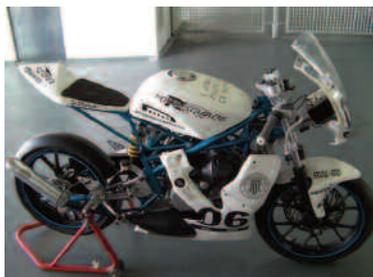
Imagen 11. Prototipo de moto de competición desarrollado por UPV Benicalap Team preparado en box para competir en Motorland en Octubre 2011.
