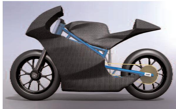
Imagen 2. Diseño de chasis y carenado final realizado con sistemas CAD a partir de tecnología de escaneado 3D, CAE estructural, etc.
