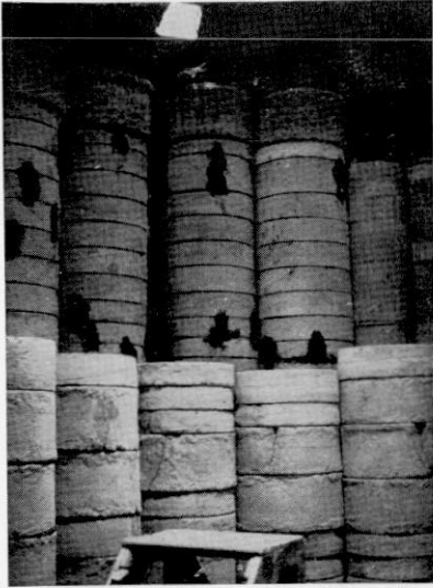
Fig. 1.—INTERIOR DE UN HORNO MORUNO. Las cacetas que contienen los objetos por cocer se apilan cuidadosamente. Encima de ellas, en la alcoba donde se abre el respiradero, piezas para bizcochar.
