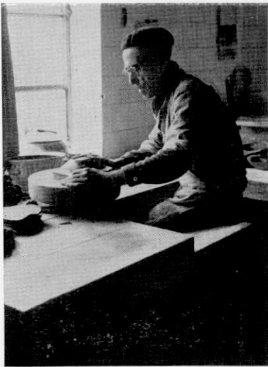
Fig. 3.—EL TORNO, INSTRUMENTO TRADICIONAL. Se utiliza no sólo para el modelado, sino también en el retoque de piezas obtenidas por diversos procedimientos.
